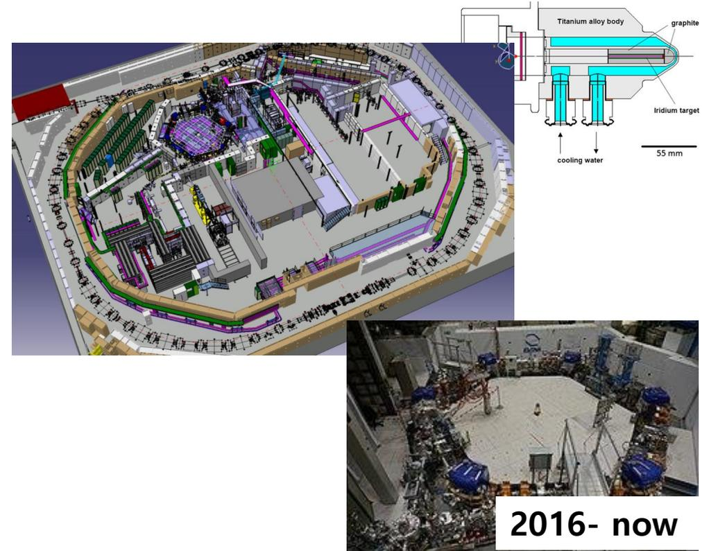
Production : Linac4( $H^-$ )  $\rightarrow$  Booster( $H^-$ )  $\rightarrow$  PS( $p$ , 26GeV/c)  $\rightarrow$  iridium target  $\rightarrow \bar{p}$  (3.5GeV/c)
